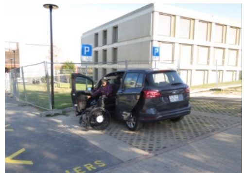
Collège à Avenches, avec Mouna Abbad membre du comité: Les places de stationnement adaptées sont en grille gazon !
