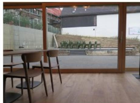
La terrasse est accessible par des portes vitrées coulissantes; il manque un marquage sur le vitrage dans les zones de sorties.
